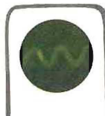
Figura 25. — Cualquier fenómeno en movimiento o en acción sólo es posible analizarlo considerando cada instante y para conseguir la sucesión de los instantes hemos de marcar el tiempo, lo cual se consigue en la electrónica de los tubos de rayos catódicos por medio de una tensión llamada en "diente de sierra" generada en el circuito de la base de tiempos.
