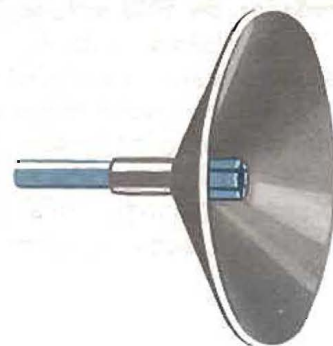
Figura 28. — Disposición del contacto de MAT y de la capa conductora en los tubos de imagen.
