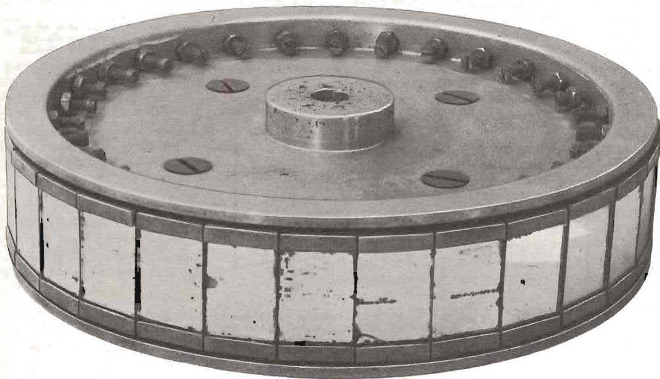
Figura 7. — Rueda de espejos que se conserva en el Museo de Ciencia y Técnica de Milán. Servía para transmisiones experimentales. Para la reconstrucción de una imagen se utilizaba el principio de la desviación de un rayo modulado.
