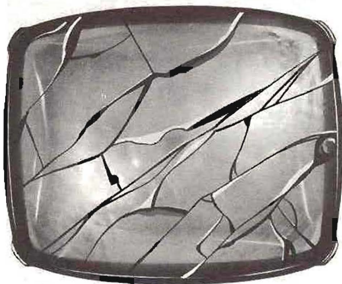
Figura 34. — En caso de implosión, las carátulas de resina poliéster —reforzada con fibra de vidrio— no se rompen, sino que a lo máximo se agrietan.
