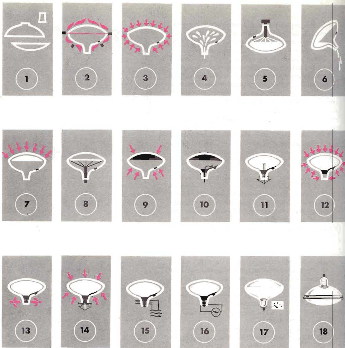
Figura 37. — Ilustración del proceso de fabricación de un tubo de imagen Miniwatt. 1) Partes de vidrio: cuello, cono, pantalla frontal. 2) Soldadura de los componentes de vidrio, conexión de alta tensión. 3) Pavonado con enfriamiento controlado para eliminar las tensiones mecánicas. 4) Lavado interno de la ampolla para eliminar eventuales residuos. 5) Formación de la pantalla fluorescente con proceso de decantación de suspensión de fósforos. 6) Eliminación de la solución después de que el fósforo se deposita sobre la pantalla. 7) Secado del fósforo depositado dentro de la ampolla. 8) Pulverización sobre la superficie del fósforo de una película homogénea de laca. 9) Secado de la capa de laca. 10) Conexión del terminal de alta tensión al interior del cuello gracias a una capa de grafito. 11) Deposición de una capa de aluminio. 12) Cocción de la ampolla para eliminar materias orgánicas, comprendida la película de laca. 13) Cierre del cañón electrónico en el cuello. 14) Nuevo calentamiento y expulsión del aire. 15) Eliminación de los residuos de gas. 16) Encendido del filamento para efectuar la activación del cátodo. 17) Control del tubo. 18) Aplicación de la cubierta o aro protector al borde del tubo. 19) Se pulveriza sobre el cono una capa conductora de grafito. 20) Control del tubo. 21) Embalaje definitivo.
